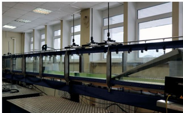
Рис. 5. Экспериментальная установка по моделированию волн цунами в НИУ МГСУ
